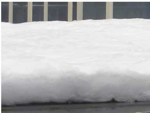
ブラウン管から再生されたグラスウール
